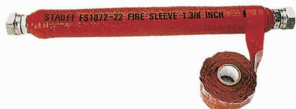
这种含氧化铁的硅橡胶粘接带可用来粘牢和封闭 FSL 防火套的两端，也可用来修补防火套上的划痕和小的损伤。防火套的两端粘住后可防止水气或油进入防火套内。
