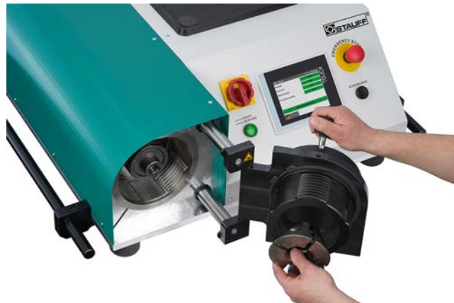
Fig. 51: Montaggio delle ganasce di formatura
