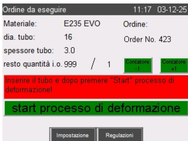
Fig. 58: Start processo di deformazione
