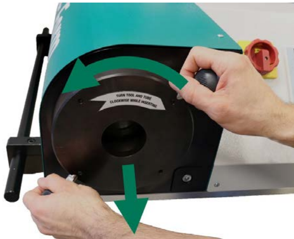
Fig. 15: Déverrouillage et sortie de la tête de serrage
