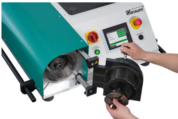
Fig. 48: Mise en place du bloc de formage
