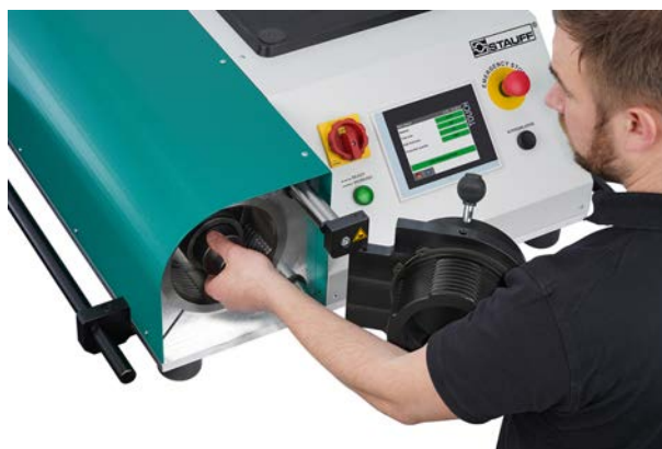
Fig. 47: Mise en place le nez de formage.
