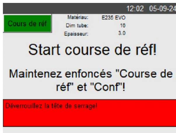
Fig. 13: Déverrouillage de la tête de serrage
