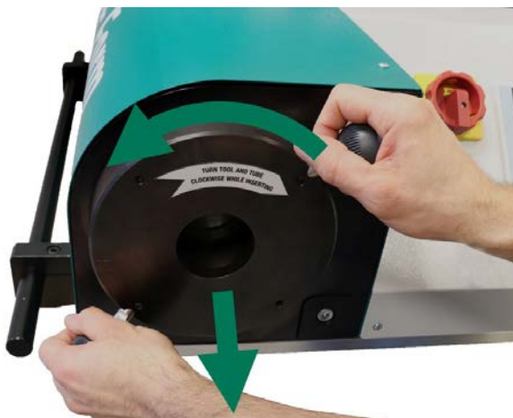
Fig. 45: Déverrouillage et sortie de la tête de serrage
