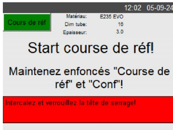
Fig. 16: Insertion et verrouillage de la tête de serrage
