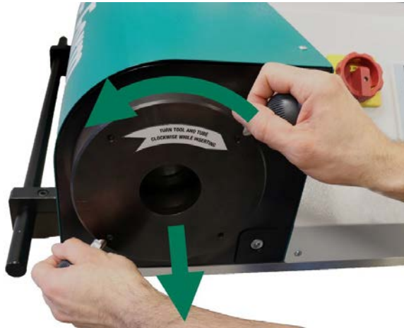
Fig. 45: Sbloccaggio ed estrazione della testa di bloccaggio
