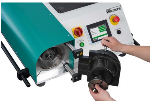
Fig. 48: Montaggio delle ganasce di formatura
