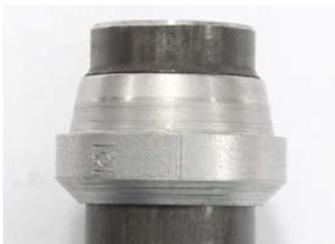
Fig. 17: Résultat du prémontage de la bague taillante
