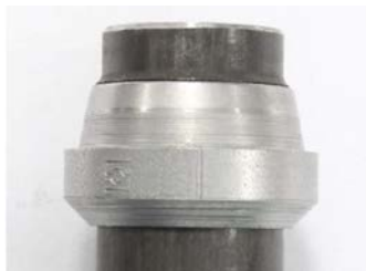
Fig. 17: Risultato del premontaggio dell'anello tagliente
