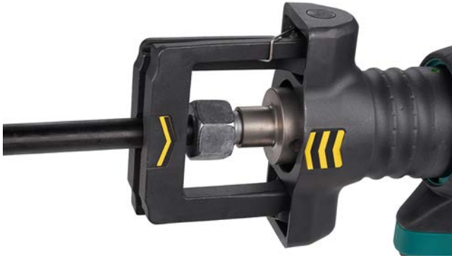
Ilustr. 16: Montaż wstępny pierścienia zacinającego
