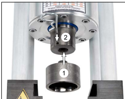
Abb. 8: Montagestutzen am Druckzylinder
