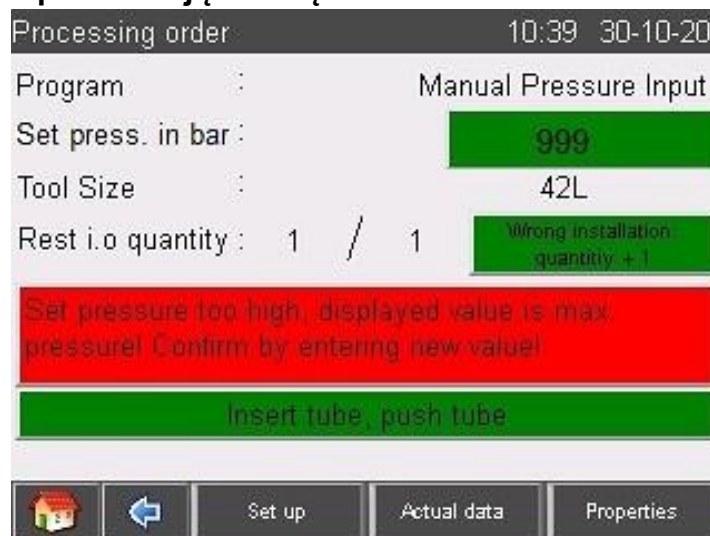
Rys. 66: Ustawione ciśnienie zbyt wysokie
