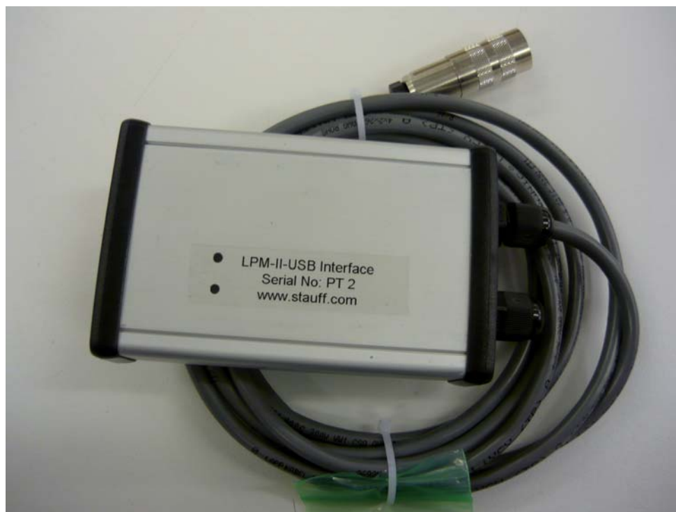
Figure 1 LPMII-USB Interface: L'unité interface USB pour l'LPMII
