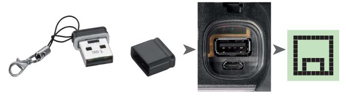
Si antes de la conexión se conecta una memoria USB, la medición de la memoria interna se almacena en la memoria USB. Entonces en la pantalla aparece: **fi DATATRAMSFER**
