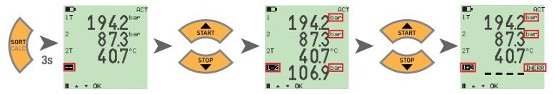
Potencia hidráulica (1\*2 -> p\*Q/600)
