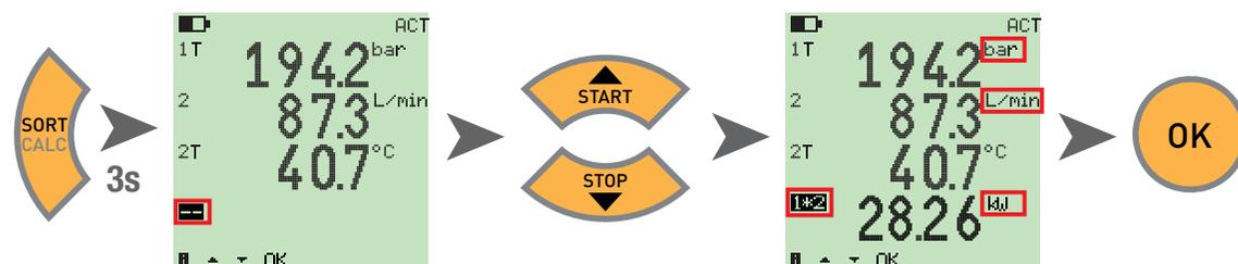
**i** Les formules disponibles sont la valeur différentielle, l'addition et le produit (multiplication). Après avoir sélectionné la formule, la vraisemblance des grandeurs de mesure est contrôlée. Si les grandeurs de mesure ne sont pas vraisemblables, le message d'erreur INERR s'affiche.
