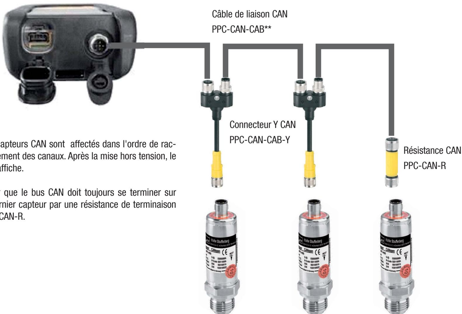
**i** Les capteurs CAN sont affectés dans l'ordre de raccordement des canaux. Après la mise hors tension, le tri s'affiche.
