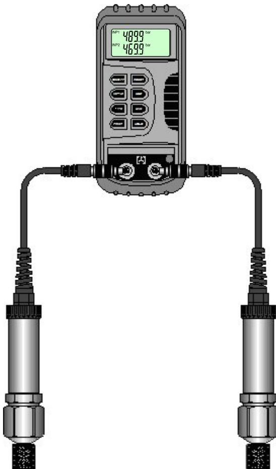
Exécuter l'ajustement des capteurs en pression de service de la machine.
