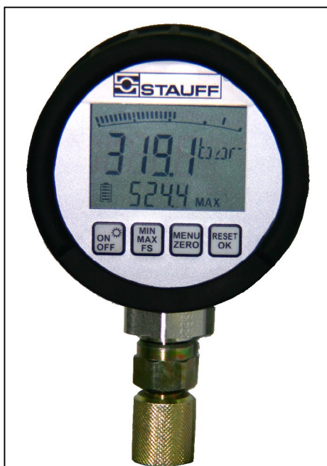
SPG-DIGI-W mit Adapter (G 1/4 auf M16x2, STAUFF TEST 20)
