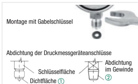
Das Anzugsmoment ist von der eingesetzten Dichtung abhängig. Um das Messgerät in die Stellung zu bringen, in der es sich am besten ablesen lässt, ist ein Anschluss mit Spannmuffe oder Überwurfmutter zu empfehlen.
