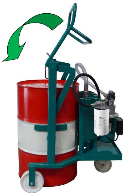
Abb. 1 Anheben des Sickenfasses
