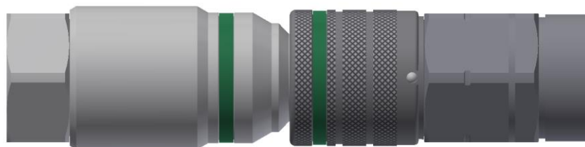
Abbildung 2. Kuppelvorgang: FC Kupplungsstecker in die FF-Kupplungsmuffe eingeschoben kurz vor dem Einrasten
