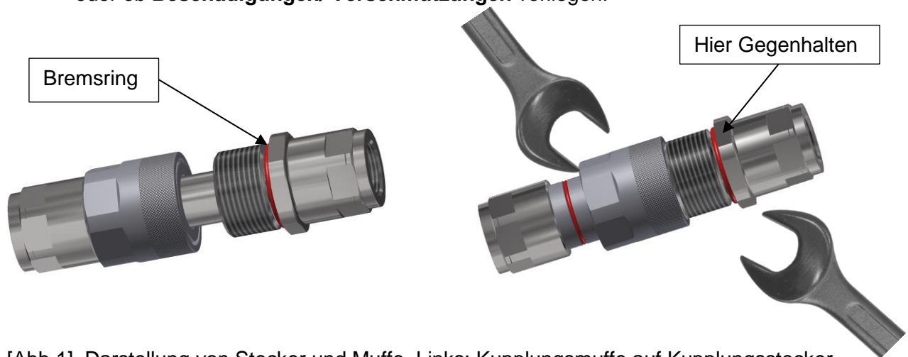
[Abb.1] Darstellung von Stecker und Muffe. Links: Kupplungsmuffe auf Kupplungsstecker aufsetzen. Rechts: mit Werkzeug Anziehen bis auf Block.
