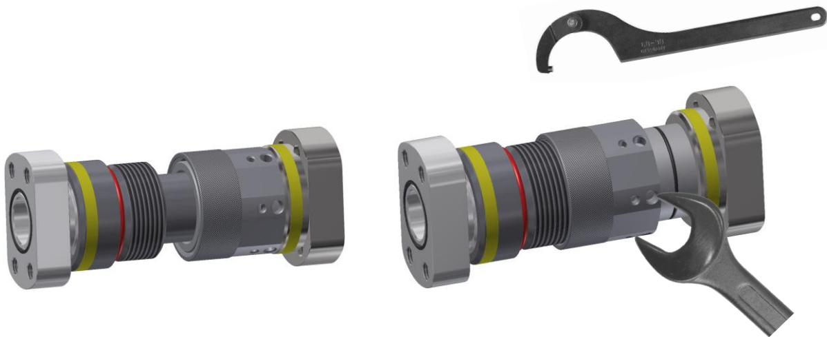
[Abb.2] Kuppelvorgang. Links: aufsetzen der Kupplungsmuffe. Rechts: Vorschieben der Schraubhülse und mit Werkzeug Anziehen bis auf Block.
