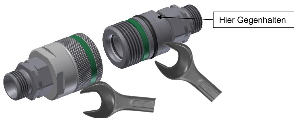
[Abb. 2] Darstellung von Stecker und Muffe: Mit Werkzeug Anziehen bis auf Anschlag.
