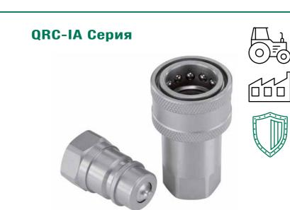
Взаимозаменяемость ISO 7241-1 Серия А DN 6 B 51 (1/4" B 2") Рабочее давление 130 в 400 bar Материалы Углеролистая сталь и Нержавеющая сталь
