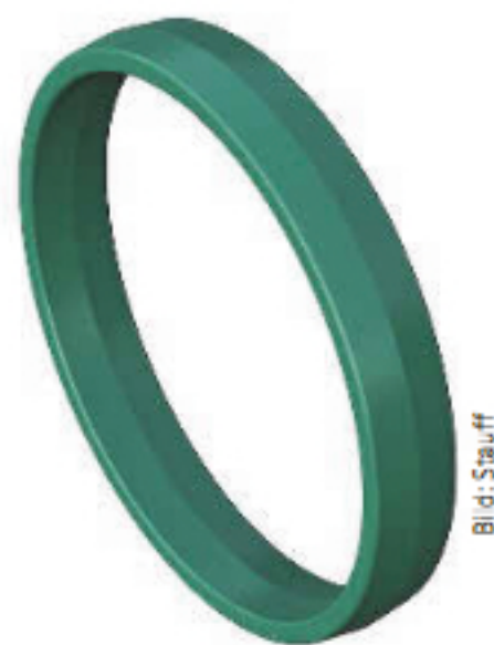
Auf das umgeformte Rohrende wird der Viton-Dichtring – wegen seines seitengleichen Profils in jedem Fall richtig herum – aufgeschoben.
