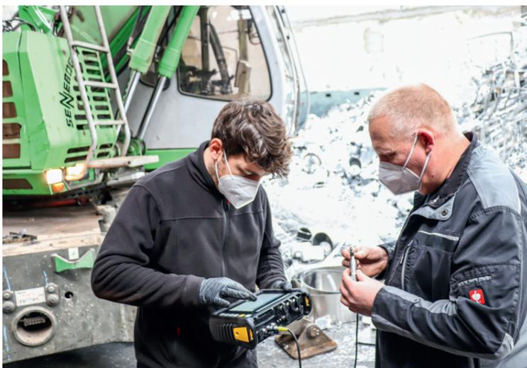
Dank der robusten Bauweise und der CAN/SAE J1039-Schnittstellen ist das PPC-Pad-Pro auch für die Betriebszustandsanalyse der Hydraulik von mobilen Arbeitsmaschinen einsetzbar.
