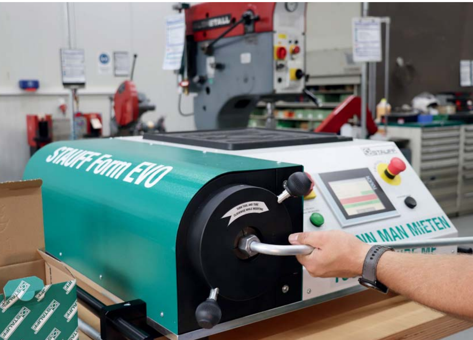
Das Umformsystem Stauff Form Evo wird für Rohrverbindungen unter extremen Bedingungen empfohlen. Bilder: Stauff
