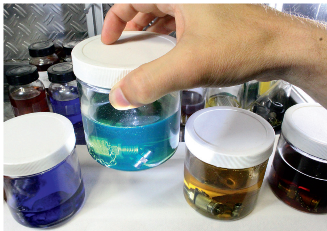
Erstausrüster können die Beschichtung auf ihre Beständigkeit gegen Düngemittel, Pestizide et cetera testen lassen.
