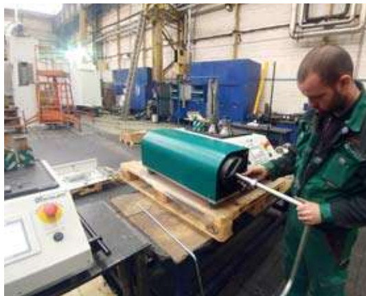
An das Ende eines konventionellen Rohres wird als Grundlage der „formschlüssigen Verbindung“ eine Kontur angeformt. Bild: Pisman
