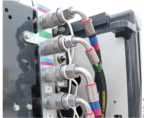
Die Rohrleitungskupplungen sind vom Prinzip her beidseitig absperrende Schraubkupplungen mit flachdichtenden Ventilstößeln.
