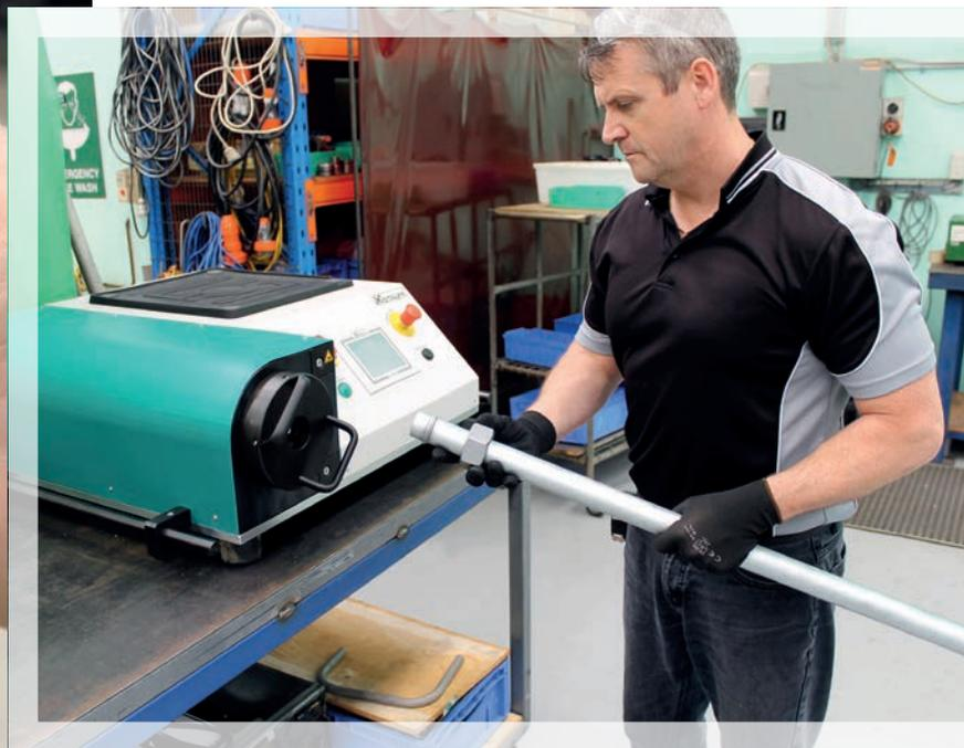
**01** Montagemaschinen wie diese Rohrumformmaschine lassen sich künftig einfach über eine Cloud-Anbindung überwachen
